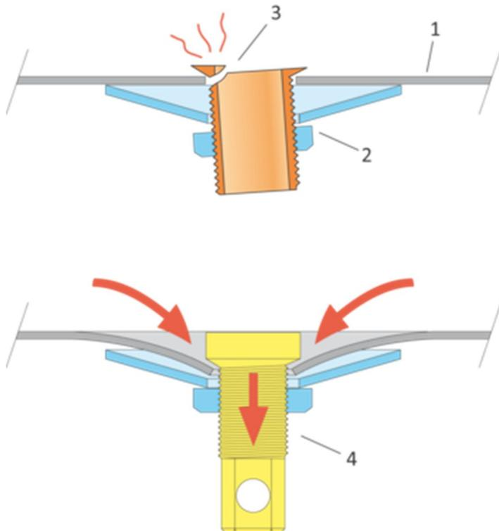
Sur les parois de conduit plus épaisses (1), l'écrou (2) doit être serré plus fortement.
